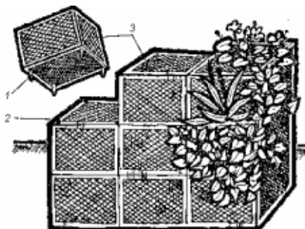
Рис. 5. Цветочная стена из отдельных элементов: 1 — шипы; 2 — пазы; 3 — одинаковые «строительные элементы».
